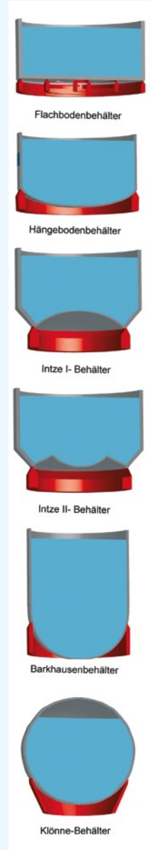
▲ Bild 34. Schematische Gegenüberstellung der Behälter- formen.
